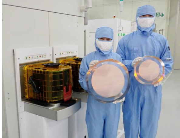
رقاقة سيليكون مقاس ١٢ بوصة ومعدات قياس المقاومة، معروضة لأغراض مرجعية بجانب رقاقة مقاس ٨ بوصة (على اليمين)
