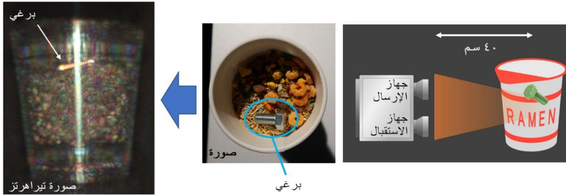
نتائج اختبار الفحص غير المدمر (الكشف عن وجود برغي معدني داخل كوب مكرونة)
