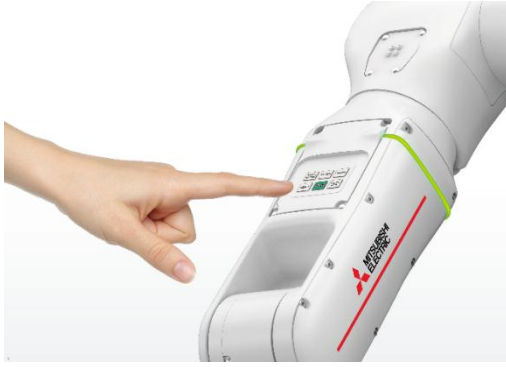
تتيح لوحة التحكم المخصصة الموجودة في ذراع الروبوت تعلم حركات الروبوت وتسجيلها بسهولة
