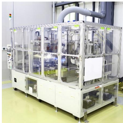
آلة طلاء بالكهرباء ذات الانزلاق الآلي وخاصية الإنتاج ذي القطعة الواحدة
