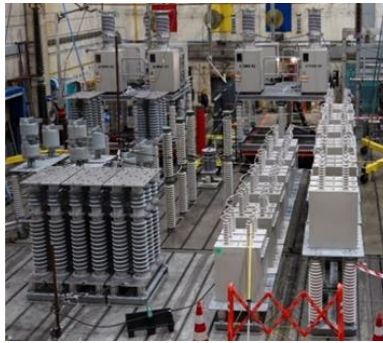
النموذج الأولي لقاطع DCCB الميكانيكي بقوة ١٦٠ كيلو فولت المستخدم في الاختبارات
