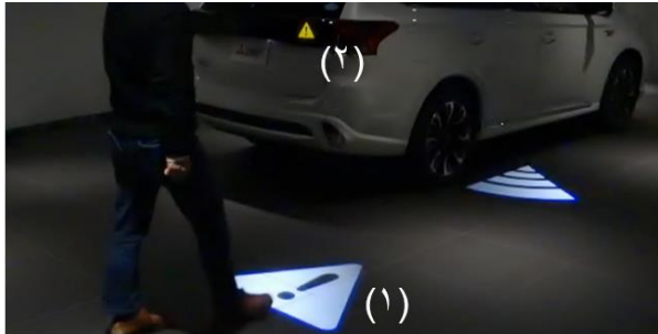
ثلاثة أنواع (١ و ٢ و ٣) من الرسوم الضوئية المتحركة تتغير عندما تكتشف المستشعرات مشاة مجاورين
