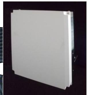
وحدة تردد راديوي ثنائية الأشعة للهوائي مع عناصر هوائيات ضخمة (٥١٢ عنصر هوائي)
